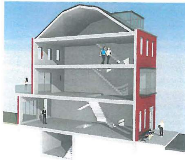
Karakteristieke doorsnede Nieuw Herenhuis
