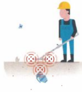
Afb. 5: werkingsprincipe actieve detectie
