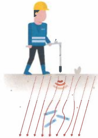
Afb. 4: werkingsprincipe passieve detectie
